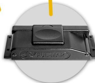
**GPS AVL DX-03:** Con este dispositivo, obtenemos la localización del vehículo y el envío de todas las transacciones del reloj en tiempo real, permitiendo obtener, km. recorridos, importes, tiempos logrando una óptima Gestión de flota
